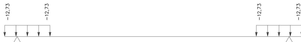
Obrázok 12 - Rovnomerné zaťaženie od rozšírenia stien nosníkov
